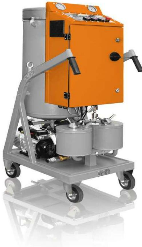
L'unità di degasaggio dell'olio portatile **CMM-0.6 GlobeCore** può essere utilizzata per la **filtrazione** dell'olio, il **pompaggio** di olio, il **riscaldamento** dell'olio e il **degasaggio** di olio isolante dielettrico, nonché la **rimozione di impurità meccaniche e umidità**. La capacità di elaborazione dell'unità è di 0,6 m<sup>3</sup> / ora.
