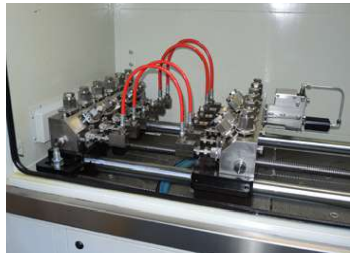
Banco per prova ad impulsi secondo norma SAE (interno) Bench for impulse pressure test according to SAE standard (inside)
