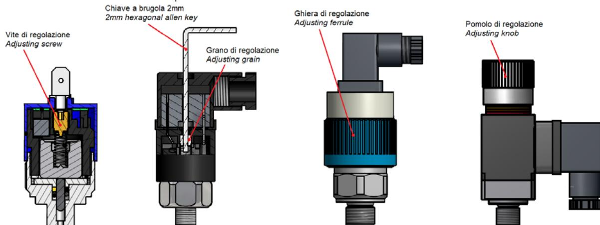
**TARATURA PRESSOSTATI ELETTRONICI**
