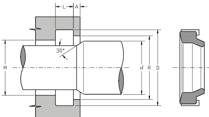
L'anello smorzatore AMM è stato appositamente sviluppato per l'impiego nei sistemi di frenatura di fine corsa nei cilindri pneumatici.
